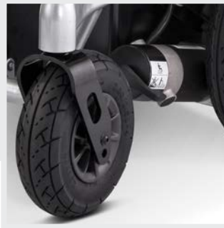
Ruedas giratorias con llantas de aluminio
