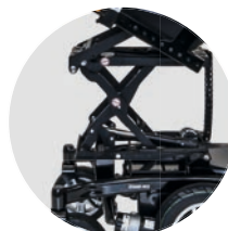
Inclinación eléctrica del asiento con elevación de tijera opcional de 300 mm
