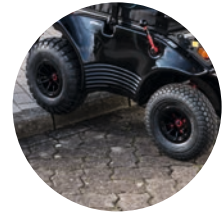
Capacidad para escalar obstáculos de hasta 110 mm
