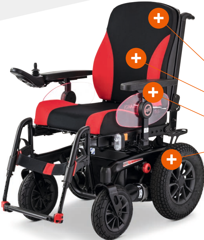
Inclinación eléctrica del asiento con elevación de tijera opcional de 300 mm
